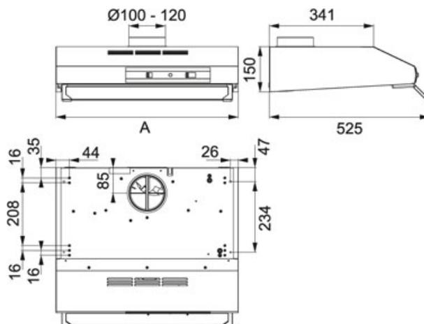
Hotte visière FTT 632 XS FM, 60cm , Inox , éclairage LED 1 x 4W, classe énergétique D, débit max 295m<sup>3</sup>/h, niveau sonore mini 56 dB/maxi 69 dB, commandes électroniques, moteur 125W, 2 filtres à graisse métal, FRANKE.
